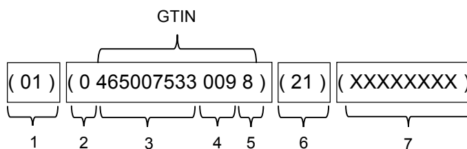
Fig. 12. The GS1-128 barcode
